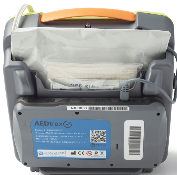
Figure 2 AEDtrax monté sur un dispositif ZOLL AED 3
